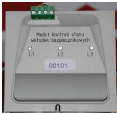
Rys. 2. Moduł kontroli stanu wkładek bezpiecznikowych
