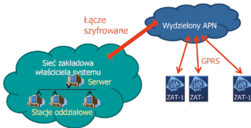
Rys.1. Koncepcja systemu „Zabezpieczenie Antykradzieżowe Transformatorów” (Z.A.T.)
