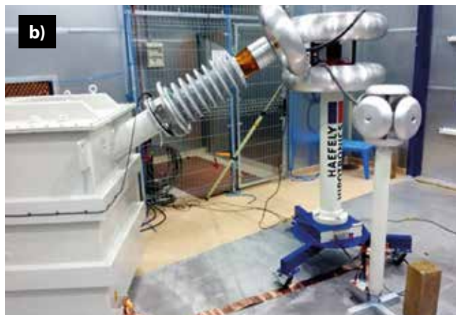
Rys. 3. Stanowisko do pomiaru WNZ – Instytut Energetyki Warszawa – Mory; a) widok wnętrza klatki Faradaya oraz drzwi wjazdowych, b) zespół probierczo-pomiarowy.
