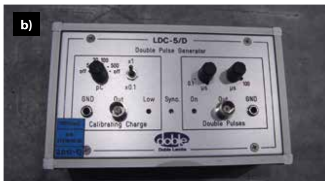
Rys. 4. Analizator wyładowań niepełnych PD-SMART – Doble Lemke; a) widok analizatora w wersji przenośnej wraz z komputerem PC i sterownikiem regulatora napięcia Haefely Hipotronics, b) kalibrator ładunku – Doble Lemke.
